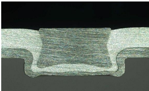
Bild 2 zeigt das Schliffbild einer ClinchNiet®-Verbindung
