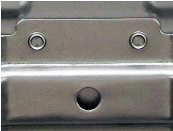
Bild 1 zeigt eine geclinchte TOX®-Rund-Punkt-Blechverbindung
