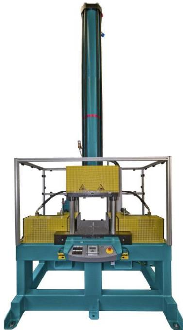
Bild 2 zeigt den mit 430 mm (zwischen den Säulen) großen Werkzeug-einbauraum mit einer Basisaufnahme für Gusswerkstücke, die hier sowohl in horizontaler als auch in vertikaler Achse gerichtet bzw. kalibriert werden können
