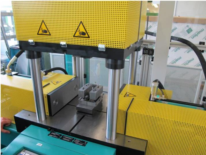
Bild 3 zeigt das Baukastensystem an TOX<sup>®</sup>-Pressen der Baureihe MAG; die 4-Säulen-Pressengestelle können mit verschiedensten Pressenantrieben individuell ausgerüstet werden
